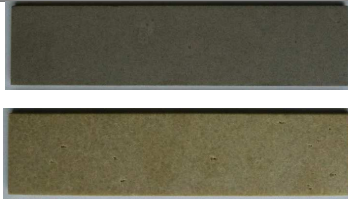
Fig. 8 Eprouvettes pour essai d'attaque par HF (En haut, THTZ-B ; en bas THTZ-N)
