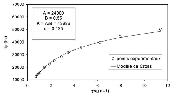
Fig. 5. Détermination des paramètres de la loi d'écoulement.
