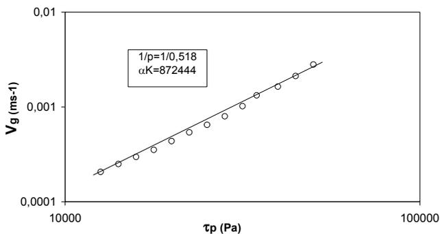
Fig. 4. Détermination des paramètres de la loi de glissement
