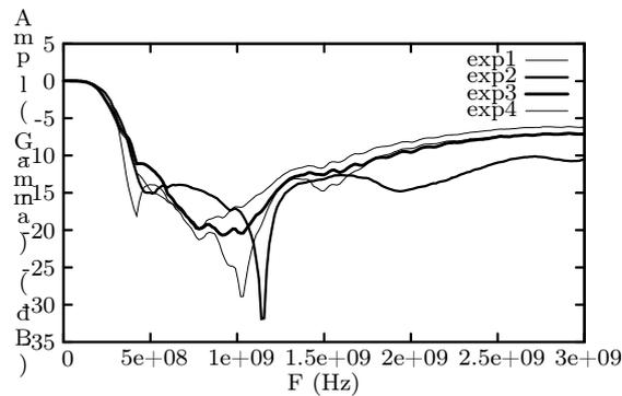
FIG. 9 – Détection du délaminage dans le composite carbone/époxy. Epreuve de 8 mm d'épaisseur réinstrumentée. Amplitude du coefficient de réflexion en fonction de la fréquence ( $F$ , unité : Hz). exp1 : mesure sur l'éprouvette n°89 après instrumentation avant essai, exp2 : mesure sur l'éprouvette n°89 rompue après ré-instrumentation, exp3 : mesure sur l'éprouvette n°86 rompue après ré-instrumentation, exp4 : mesure sur l'éprouvette n°87 rompue après ré-instrumentation.
