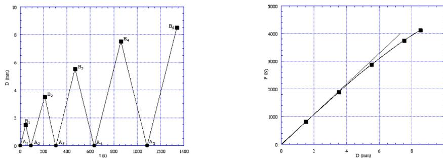
FIG. 2 – Déplacement type appliqué ( $D$ , unité : mm) en fonction du temps ( $t$ , unité : s) et courbe force maximale mesurée ( $F$ , unité : N) en fonction du déplacement maximum atteint ( $D$ , unité : mm) aux points  $(B_i)_{i=1,\dots,5}$ .
