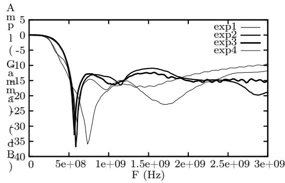
FIG. 8 – Détection du délaminage dans le composite carbone/époxy. Epreuve de 6 mm d'épaisseur réinstrumentée. Amplitude du coefficient de réflexion en fonction de la fréquence ( $F$ , unité : Hz). exp1 : mesure sur l'éprouvette n°65 après instrumentation avant essai, exp2 : mesure sur l'éprouvette n°65 rompue après ré-instrumentation, exp3 : mesure sur l'éprouvette n°66 rompue après ré-instrumentation, exp4 : mesure sur l'éprouvette n°67 rompue après ré-instrumentation.
