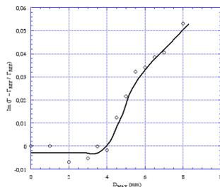
FIG. 3 – Détection des ruptures de fibres dans le composite verre/époxy. Partie imaginaire du coefficient  $\frac{\Gamma - \Gamma_{REF}}{\Gamma_{REF}}$  (sans unité) en fonction du déplacement maximum atteint ( $D_{MAX}$ , unité : mm) (Issues de mesures aux points  $(A_i)_{i=1,\dots,5}$ ) (Fig. 2)).
