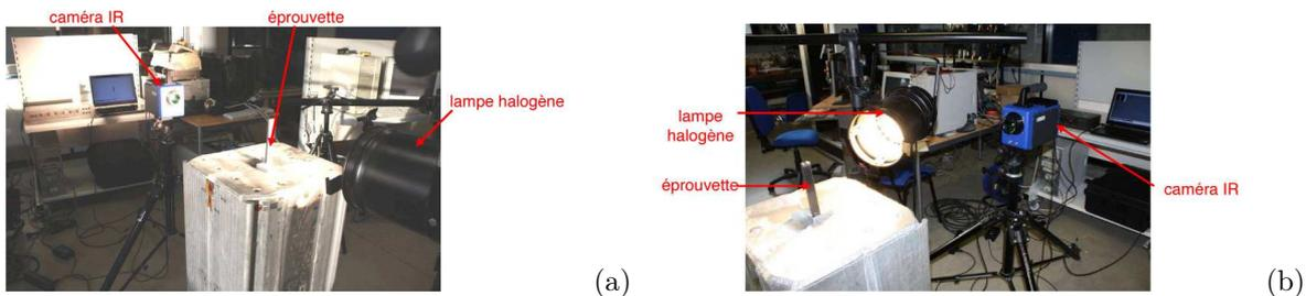
FIG. 10 – Dispositif expérimental de thermographie infrarouge. (a) Cas de la transmission. (b) Cas de la réflexion.
