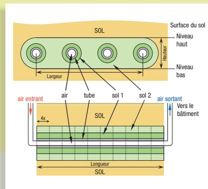
l'air de ventilation en le faisant circuler dans des tubes enterrés (le sol est plus frais que l'air extérieur en été, et plus tempéré en hiver) ; d'autre part les systèmes de production combinée de chaleur et d'électricité de petite puissance (micro-cogénération) à partir de granulés de bois.
