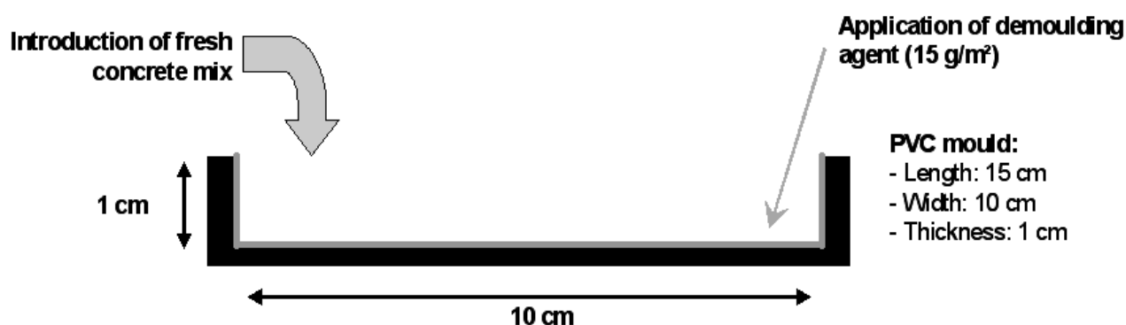
Figure 2 : Représentation schématique du procédé de coffrage
