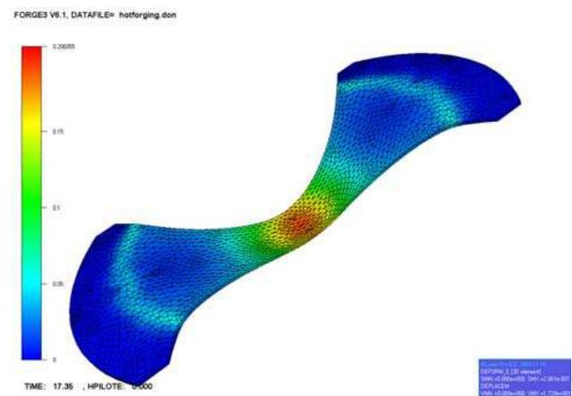
Fig. 2. Simulation d'un essai Nakazima avec Forge3<sup>®</sup>
