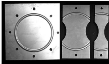
Fig. 1. Exemples de géométries d'échantillons de tôles pour des essais Nakazima
