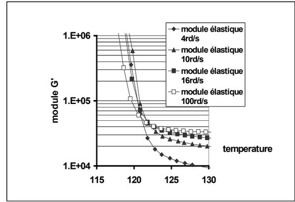
Figure 6 : Evolution des modules pour différentes vitesses de refroidissement
