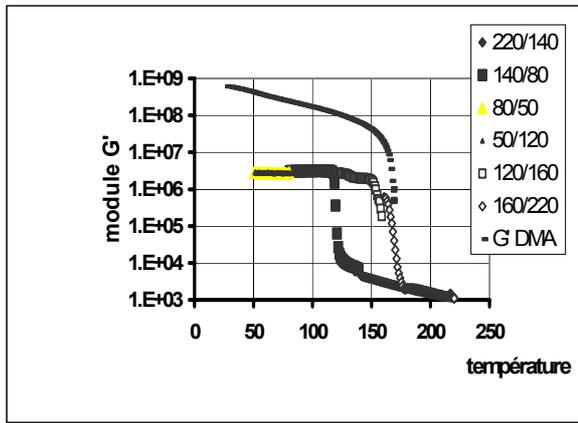
Fig 2 : module élastique en fonction de la température
