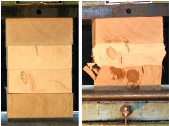
*Fig. 41 : Essai sandwich en compression simple*
