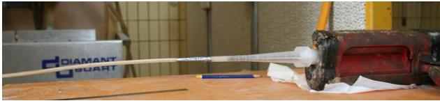
Figure 12: outil pour le scellement de la tige dans le tube métallique et vue pendant l'opération
