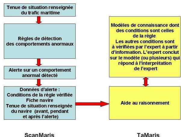
Dans le schéma, les conditions des modèles de connaissance sont des informations précises qui doivent être vérifiables soit par des sources d'informations existantes, soit par des calculs faits par l'expert (avec des outils disponibles comme par exemple la mesure d'une distance à la côte, etc.) ou soit par une décision de l'expert basée sur ses propres connaissances.
