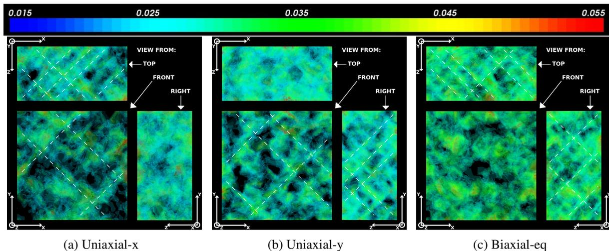
Fig. 4 – Vues en transparence des isosurfaces de  $\Sigma\gamma_{cum}$  dans les 3 directions de l'espace, pour différents cas de chargements.
