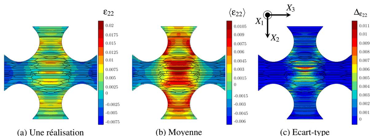
FIGURE 3 – Cartographies des valeurs aux points de Gauss (a) de la composante transverse  $\epsilon_{22}$  du tenseur des déformations pour une pièce virtuelle, (b) de la moyenne pour dix jeux d'orientations et (c) de l'écart-type, après un chargement biaxial de traction monotone avec un déplacement relatif de  $400\ \mu\text{m}$ .
