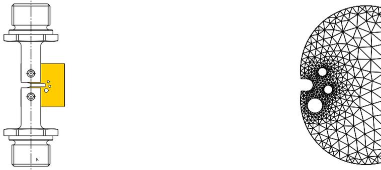
FIGURE 8 – Essai de traction sur une éprouvette complexe. Schéma de l’essai à gauche et maillage utilisé pour la simulation à droite.
