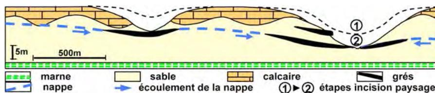
Figure 4 - Schéma de formation des grès en lentilles superposées dans les zones d'écoulement de la nappe phréatique (document Médard Thiry).
