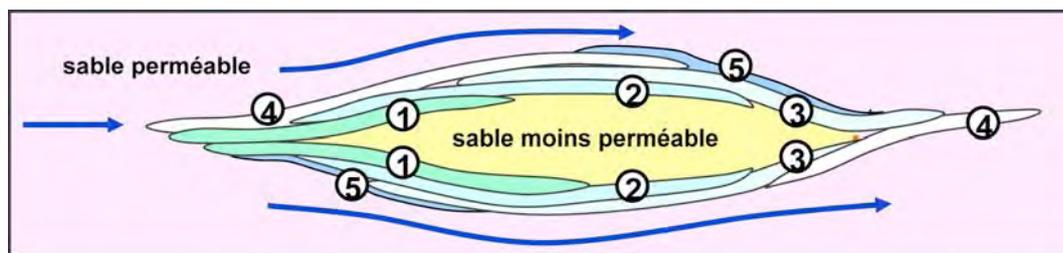
**Figure 11** – Schéma montrant la conservation de zones sableuses, non silicifiées, au sein d'une dalle gréseuse. Les numéros indiquent les étapes successives de silicification. Échelle variable entre décimètre et 2-3 mètres (document Médard Thiry).
