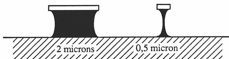
*Vue en coupe de pistes réalisées par attaque chimique pour deux générations technologiques*
