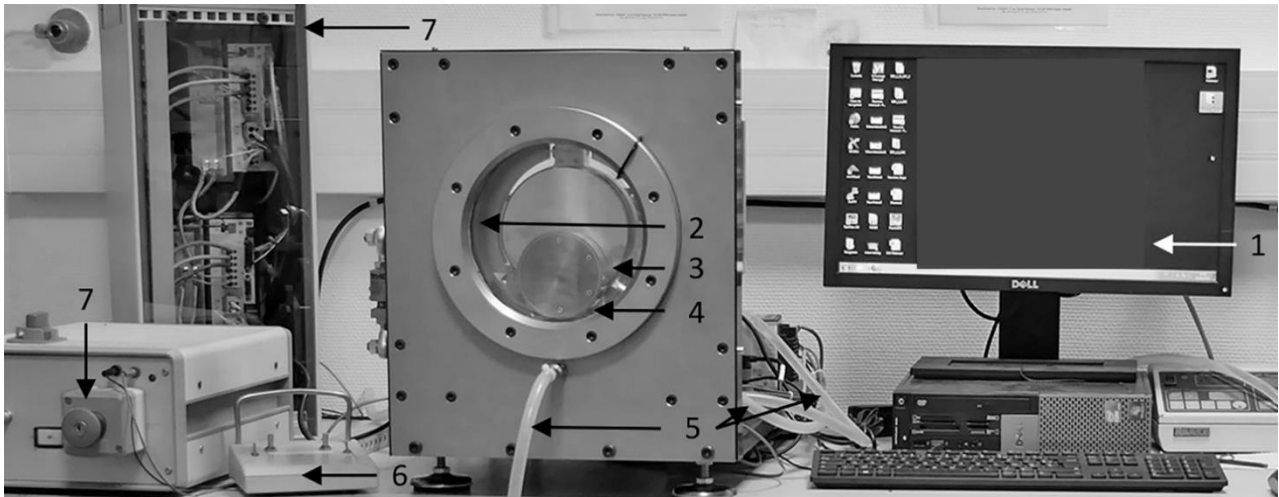
Figure 2. Cellule Couette et son environnement : 1. PC de contrôle, 2. Surface du cylindre extérieur, 3. Surface du cylindre intérieur, 4. Zone d'observation entre les deux cylindres, 5. Connexions du fluide caloporteur avec les bains thermostatés, 6. Joystick pour régler les sens de rotation des cylindres et leurs vitesses. 7. Armoire de commande.
