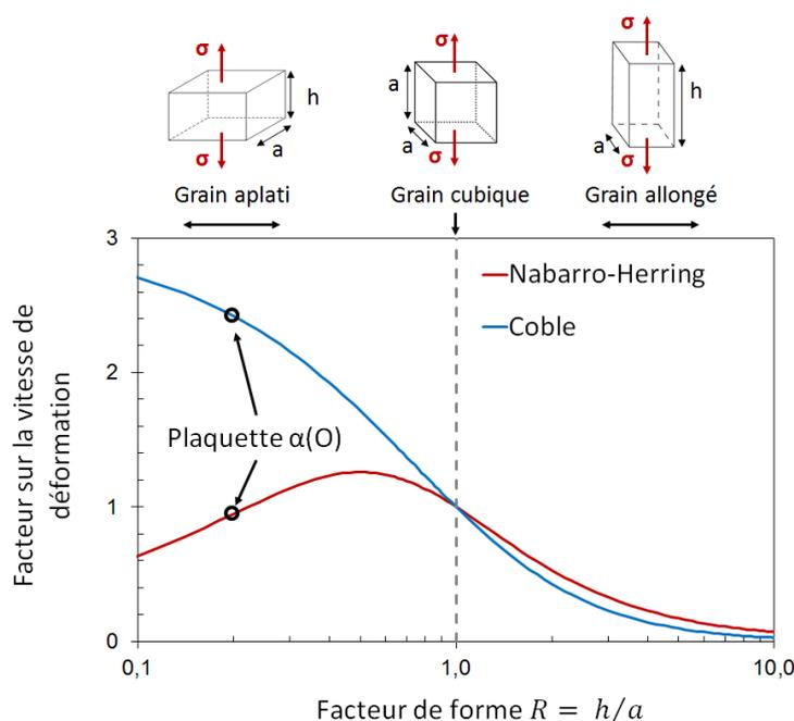
FIGURE III.44 – Sensibilité de la vitesse de fluage au facteur de forme  $R$  à volume constant d'un grain parallélépipédique à section carrée, pour les régimes de fluage diffusionnel, d'après Nix [255].
