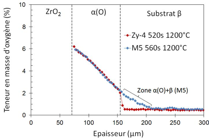
FIGURE III.9 – Profils de diffusion de l'oxygène, mesurés par microsonde, dans les épaisseurs de gaines en Zircaloy-4 et en M5<sup>®</sup> oxydées à 1200 °C sous vapeur [120].
