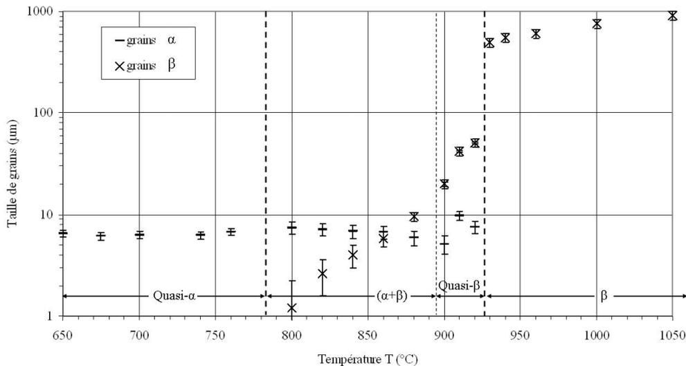
FIGURE II.11 – Tailles des grains  $\alpha$  et  $\beta$  obtenues par analyse métallographique après les essais de fluage sous vide sur éprouvettes de traction uniaxiale prélevées sur une tôle en M5<sup>®</sup> [3].
