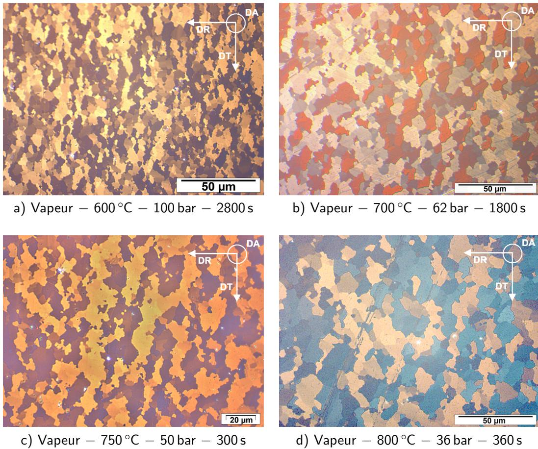
FIGURE II.36 – Microstructures après essais de fluage sous vapeur en pression interne sur Zircaloy-4 dans le domaine  $\alpha$  — micrographies optiques en lumière blanche ou polarisée.
