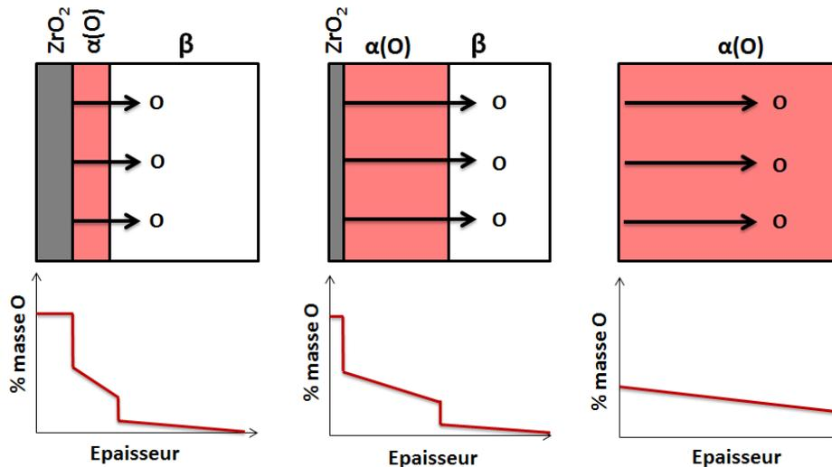
FIGURE III.23 – Schéma de l'évolution des phases et du profil de concentration en oxygène au cours du traitement thermique, à haute température sous vide, de dissolution de la zircone et de diffusion de l'oxygène.
