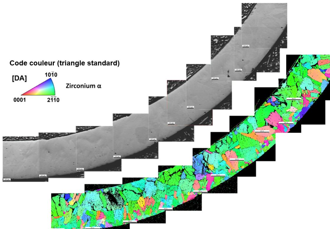
FIGURE F.3 – Cartographie de la texture locale : code couleur correspondant à l'orientation de DA dans le repère du cristal — gaine « modèle » base M5<sup>®</sup> (oxydée sous vapeur 110 s à  $1100^\circ\text{C}$  puis traitée thermiquement sous vide 3 h à  $1200^\circ\text{C}$ ).
