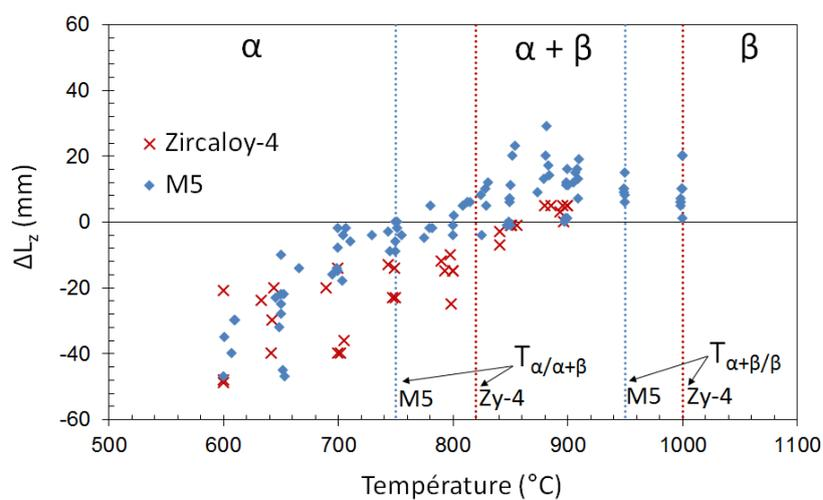
FIGURE II.27 – Variation finale de longueur des gaines après essai de fluage sous pression interne et sous vapeur en fonction de la température; Zircaloy-4 et M5<sup>®</sup>.
