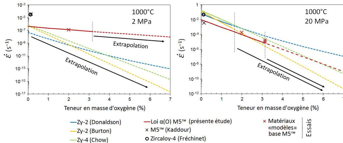
FIGURE III.55 – Extrapolations de l'effet durcissant de l'oxygène sur le comportement en fluage sous 2 et 20 MPa à 1000 °C, d'après les lois de fluage de Burton *et al.* [209], Donaldson [224], Chow *et al.* [211] et la loi  $\alpha(O)$  identifiée dans la présente étude.
