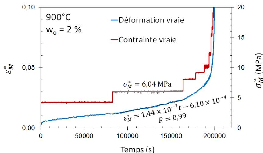
FIGURE III.39 – Déformation vraie équivalente  $\epsilon_M^*$  et contrainte vraie équivalente  $\sigma_M^*$  en fonction du temps. Essai de fluage axial sous vide à 900 °C sur gaine « modèle » base M5<sup>®</sup> contenant 2 % en masse d'oxygène.
