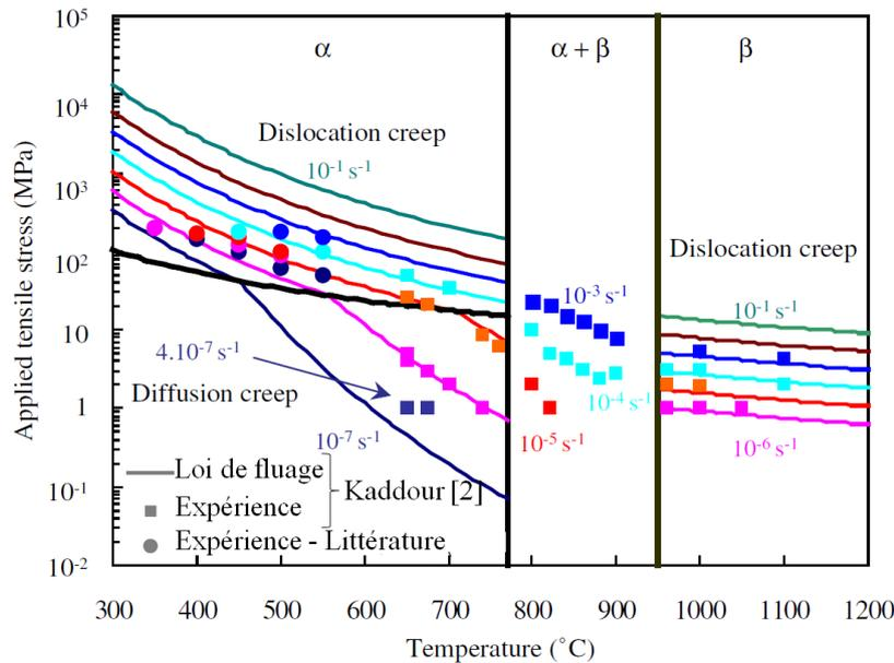
FIGURE II.15 – Carte des mécanismes de déformation pour le M5<sup>®</sup> [2].
