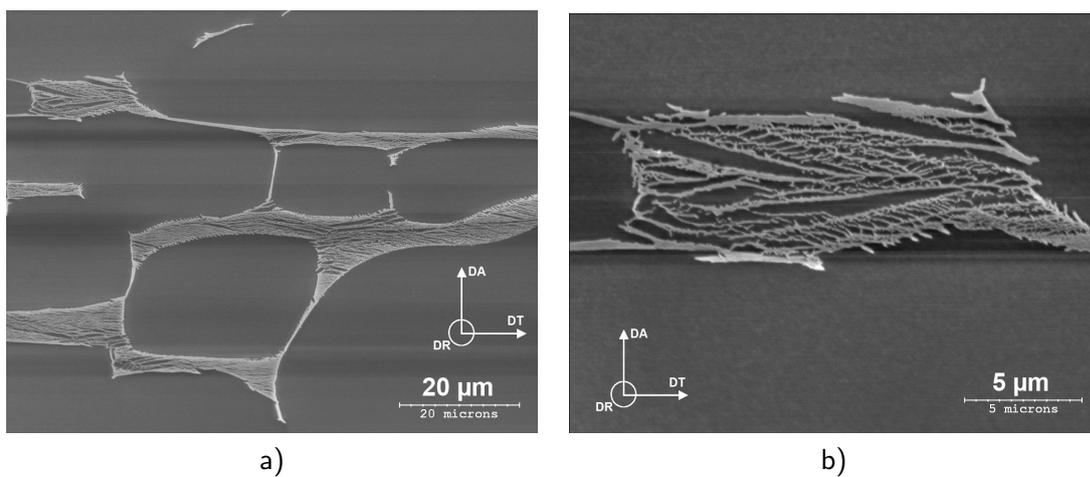
FIGURE III.32 – Micrographies électroniques de la phase  $\beta$  « résiduelle » (après une attaque chimique de dissolution sélective [2]) — gaines « modèles » base M5<sup>®</sup> contenant 2% en masse d'oxygène.
