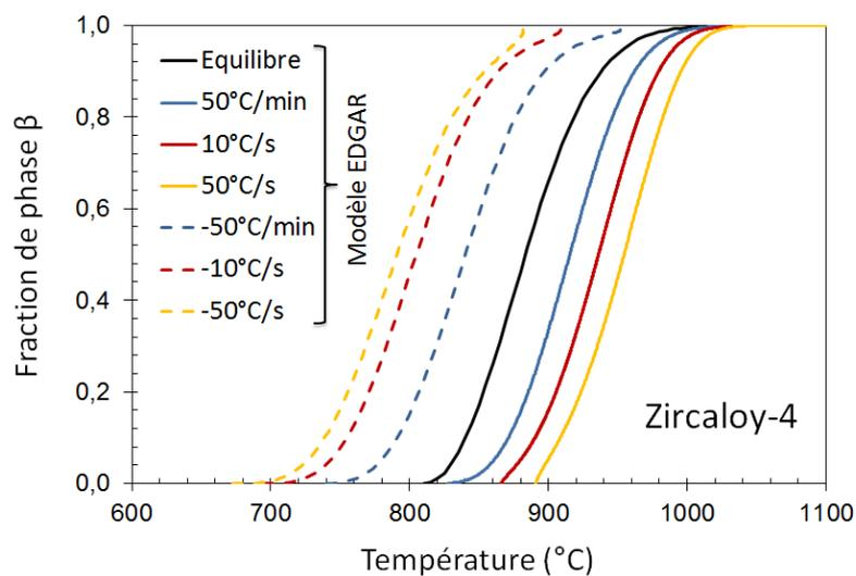
FIGURE I.20 – Évolution de la fraction de phase  $\beta$  en fonction de la température, à l'équilibre, au chauffage (trait continu) ou au refroidissement (tirets) — modèle phénoménologique EDGAR développé par le CEA pour le Zircaloy-4.
