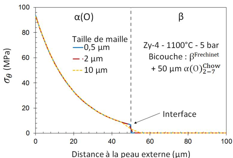
FIGURE III.64 – Profil dans l'épaisseur de la contrainte circonférentielle  $\sigma_\theta$  — Simulations EF d'un essai de fluage sur Zircaloy-4 sous 5 bar de pression interne à 1100 °C, modèle bichouche  $\beta^{\text{Frechinet}} + 50 \mu\text{m } \alpha(O)_{2-7}^{\text{Chow}}$ .
