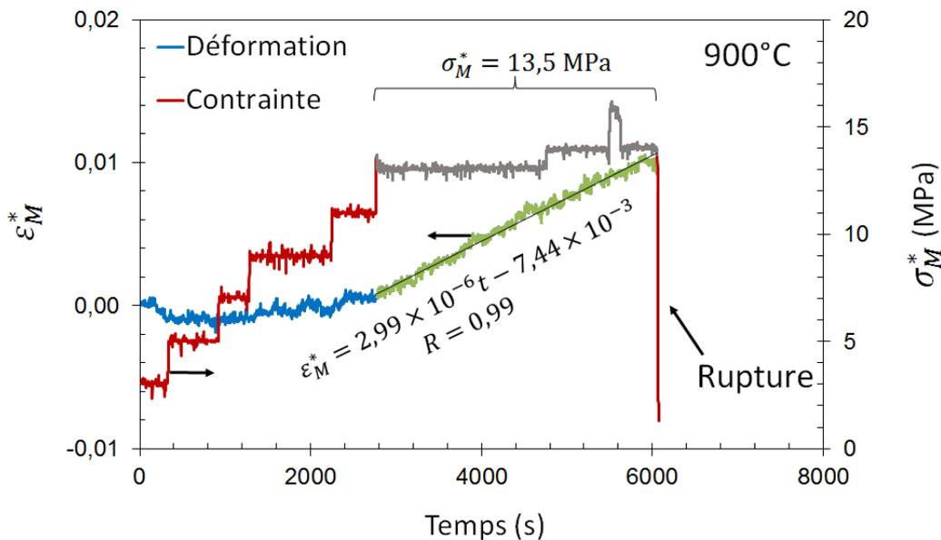
FIGURE II.60 – Déformation équivalente  $\epsilon_M^*$  et contrainte équivalente  $\sigma_M^*$  en fonction du temps — Essai de fluage axial sous vide à 900 °C après traitement thermique sous vide de 960 °C sur gaine en M5<sup>®</sup> pré-oxydée sous vapeur.
