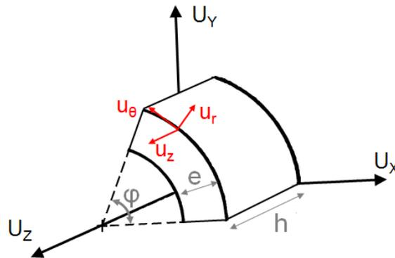
FIGURE III.60 – Schéma en fausses proportions du secteur de tube modélisé sous Cast3M.
