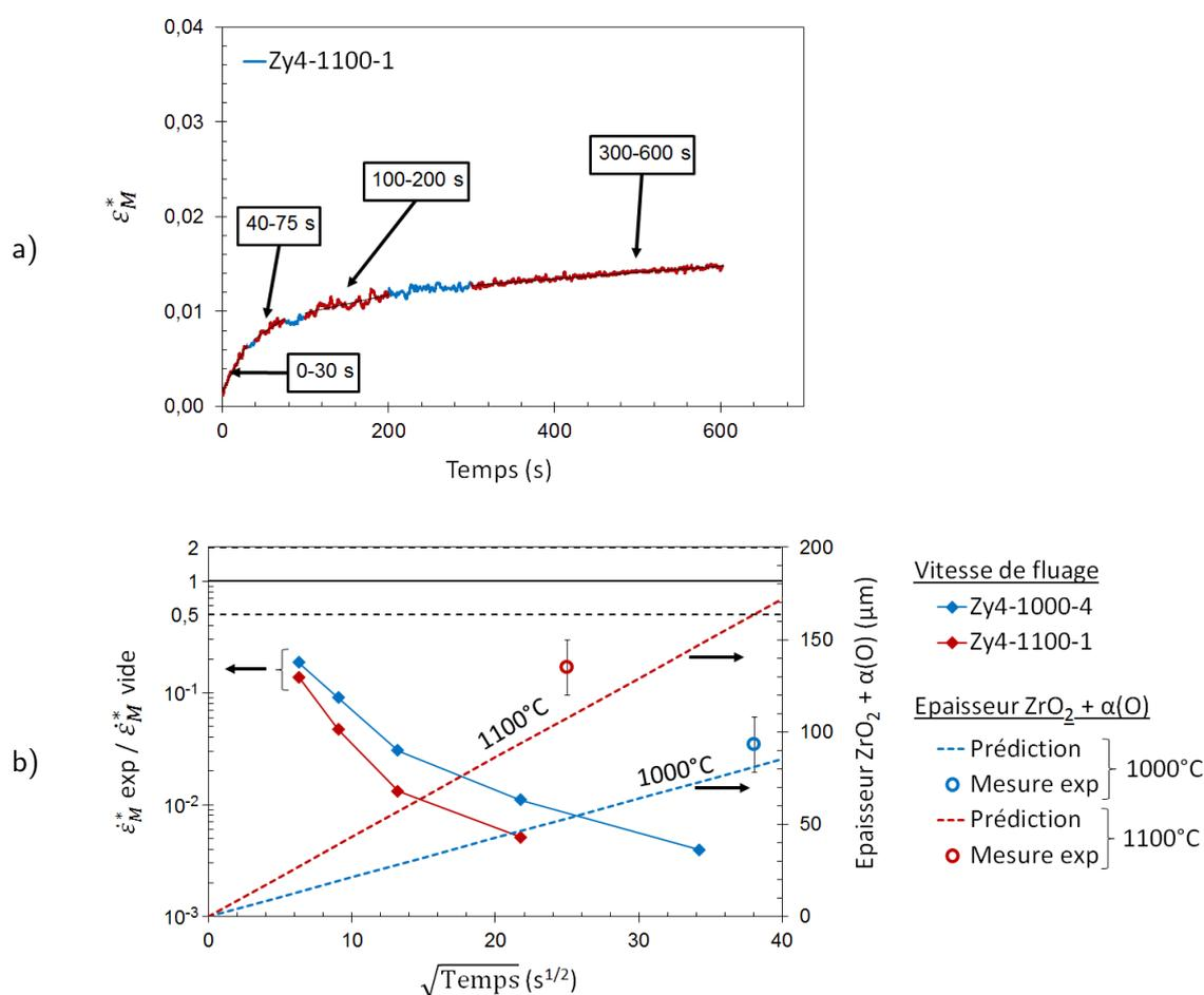
FIGURE III.57 – a) déformation vraie équivalente  $\epsilon_M^*$  en fonction du temps. Essai de fluage (Zy4-1100-1) à 1100 °C, sous 5 bar ( $\sigma_M^* = 2,8$  MPa) de pression interne et sous vapeur sur Zircaloy-4 et b) évolution en fonction du temps de l'accord vide/vapeur (à partir de la loi de fluage sous vide identifiée par Fréchet [1]) et de l'épaisseur cumulée de zircon et de phase  $\alpha(O)$  (d'après les données DEZIROX + CINOG BP [117]) — Zircaloy-4, domaine  $\beta$ .
