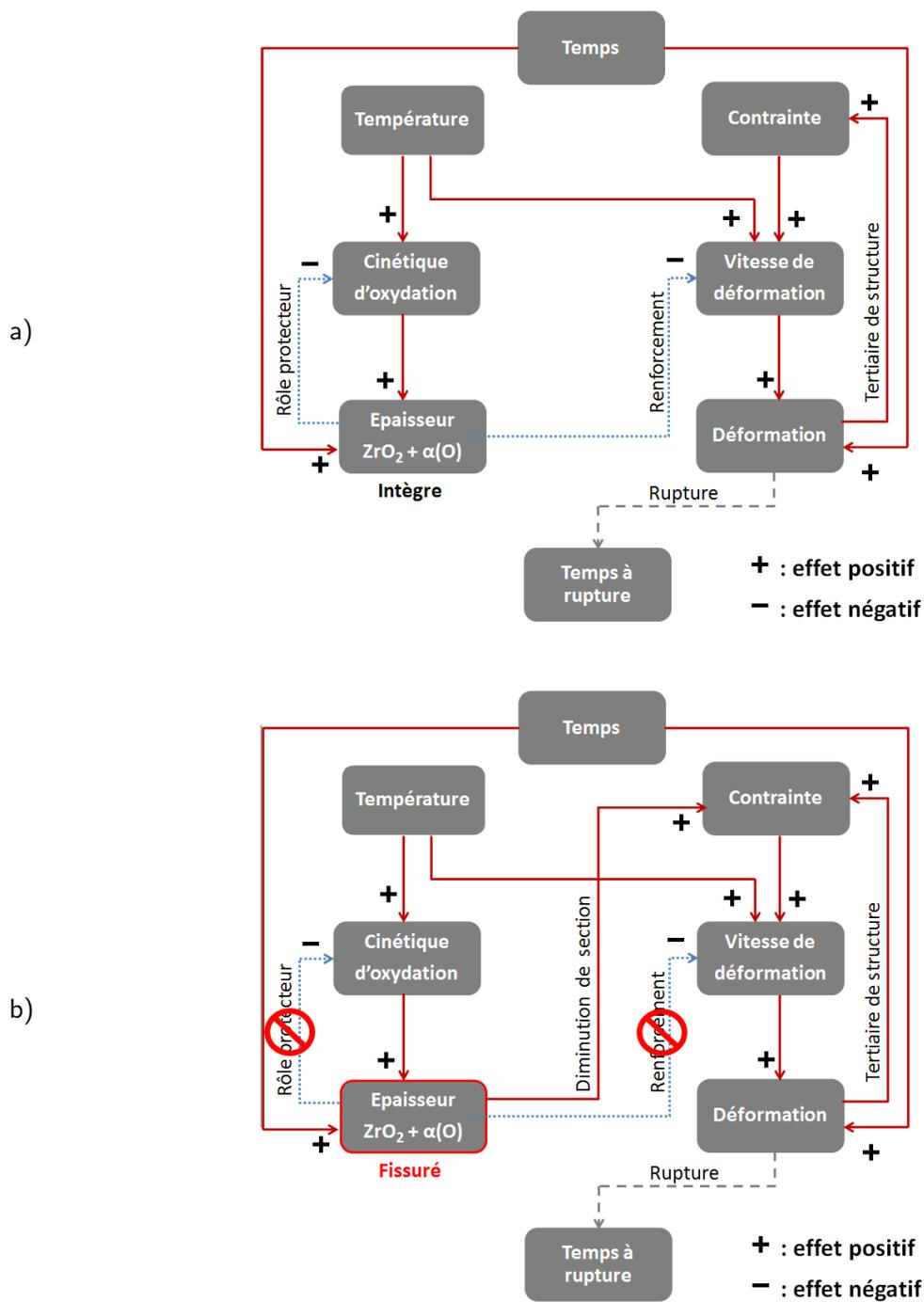
FIGURE II.55 – Représentation schématique du déroulement d'un essai de fluage sous pression interne et sous vapeur a) lorsque les couches de zircon et de phase  $\alpha(O)$  sont intègres et assurent un renforcement progressif b) lorsqu'elles sont fissurées.
