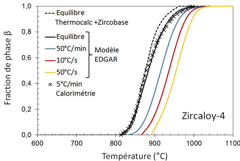
FIGURE I.17 – Évolution de la fraction de phase  $\beta$  en fonction de la température, à l'équilibre ou au chauffage — calcul Thermocalc + Zircobase, modèle phénoménologique EDGAR développés par le CEA et essais de calorimétrie [1] pour le Zircaloy-4.
