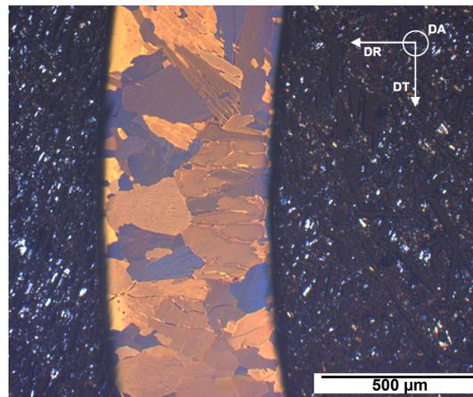
FIGURE III.29 – Micrographie optique en lumière polarisée d'une gaine « modèle », base M5<sup>®</sup>, oxydée sous vapeur 467 s à 1100 °C puis traitée thermiquement sous vide 3 h à 1200 °C.
