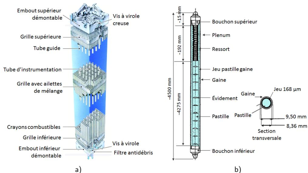
FIGURE I.2 – Vue schématique a) d'un assemblage combustible pour REP [17] et b) d'un crayon combustible pour REP 1300 MWe [14].
