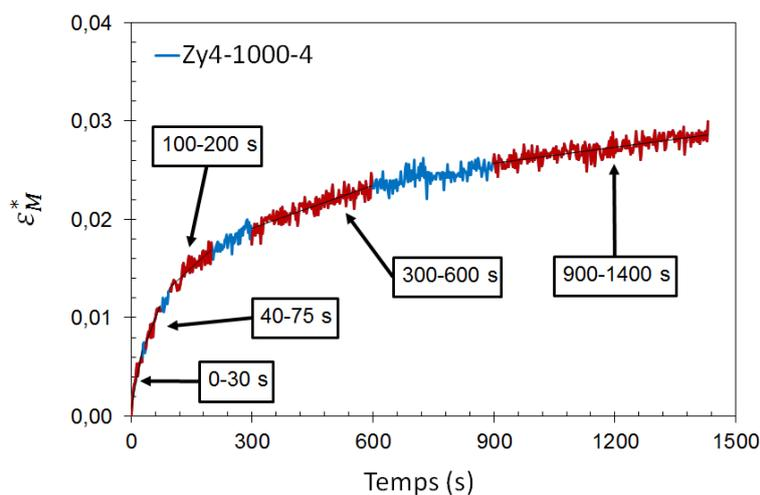
FIGURE II.49 – Déformation vraie équivalente  $\epsilon_M^*$  en fonction du temps. Essai de fluage Zy4-1000-4 à 1000 °C, sous 6 bar ( $\sigma_M^* = 3,5$  MPa) de pression interne et sous vapeur sur Zircaloy-4. Les intervalles de temps sur lesquels la vitesse de fluage a été estimée sont en rouge.
