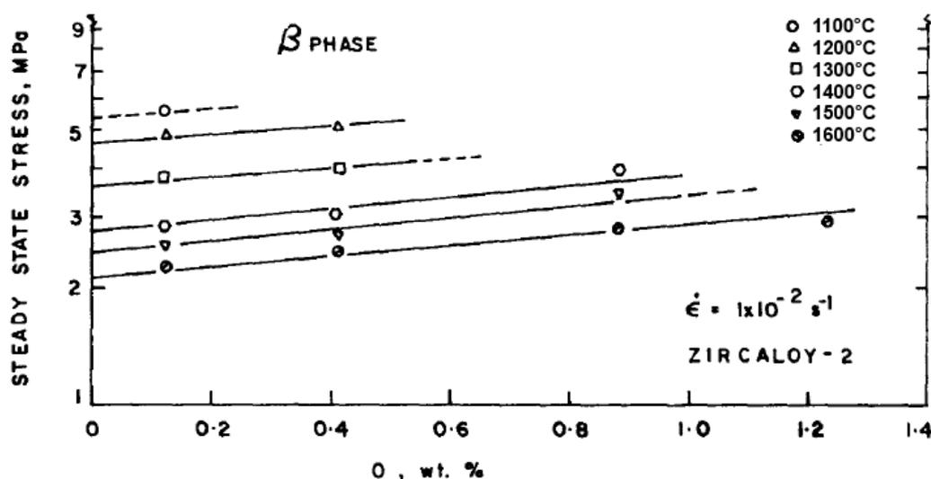
FIGURE III.7 – Évolution de la contrainte à l'état quasi-statique en fonction de la teneur en masse d'oxygène et de la température — essais de compression à  $10^{-2} \text{ s}^{-1}$  dans le domaine  $\beta$  d'un Zircaloy-2 enrichi en oxygène [213].
