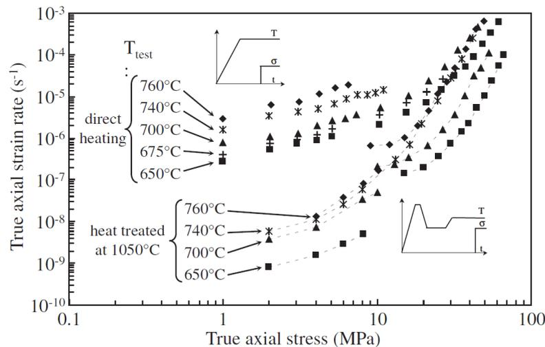
FIGURE II.5 – Évolution de la vitesse de déformation en fonction de la contrainte, alliage M5<sup>®</sup> à réception ou ayant subi un traitement thermique à 1050 °C (100%  $\beta$ ) [146].
