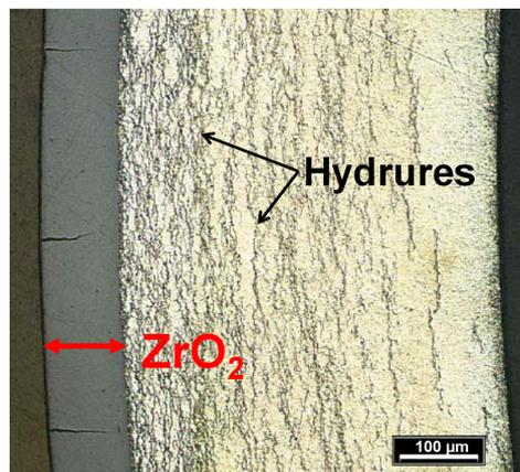
FIGURE I.3 – Couche de zircone et hydrures dans une gaine en Zircaloy-4 irradiée en REP, jusqu'à une fluence rapide ( $E > 1$  MeV) d'environ  $11,5 \times 10^{25} n cm^{-1}$  [20] — Micrographie optique.
