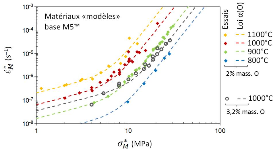
FIGURE III.53 – Vitesses de fluage en fonction de la contrainte — Essais de fluage axial sous vide sur gaines en matériaux « modèles » base M5<sup>®</sup> enrichis en oxygène et prédictions à l'aide de la loi de fluage  $\alpha(O)$ .
