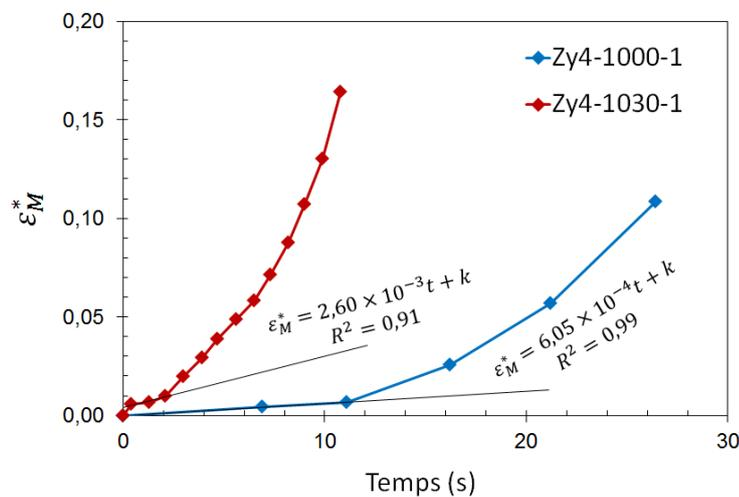
FIGURE II.47 – Déformation vraie équivalente  $\epsilon_M^*$  en fonction du temps. Essais de fluage à 1000 et 1030 °C, sous 10 bar ( $\sigma_M^* = 6$  MPa) de pression interne et sous vapeur sur Zircaloy-4.
