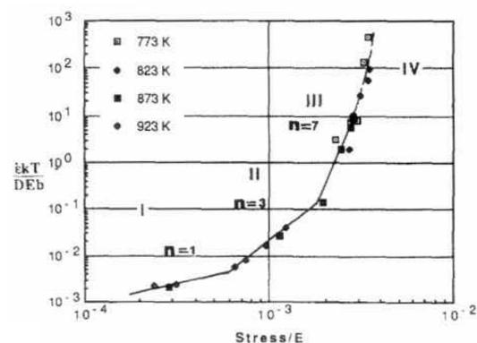
FIGURE II.4 – Évolution de la vitesse de déformation adimensionnée en fonction de la contrainte adimensionnée pour un alliage Zr - 1%Nb [142].
