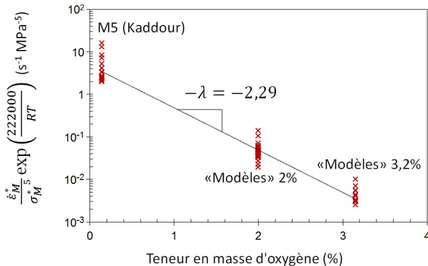
FIGURE III.52 – Vitesses de fluage normalisées en contrainte et température en fonction de la teneur en masse d'oxygène et estimation du coefficient  $\lambda$  — Essais de fluage axial sous vide sur gaines en M5<sup>®</sup> [2] et en matériaux « modèles » base M5<sup>®</sup> enrichis en oxygène.
