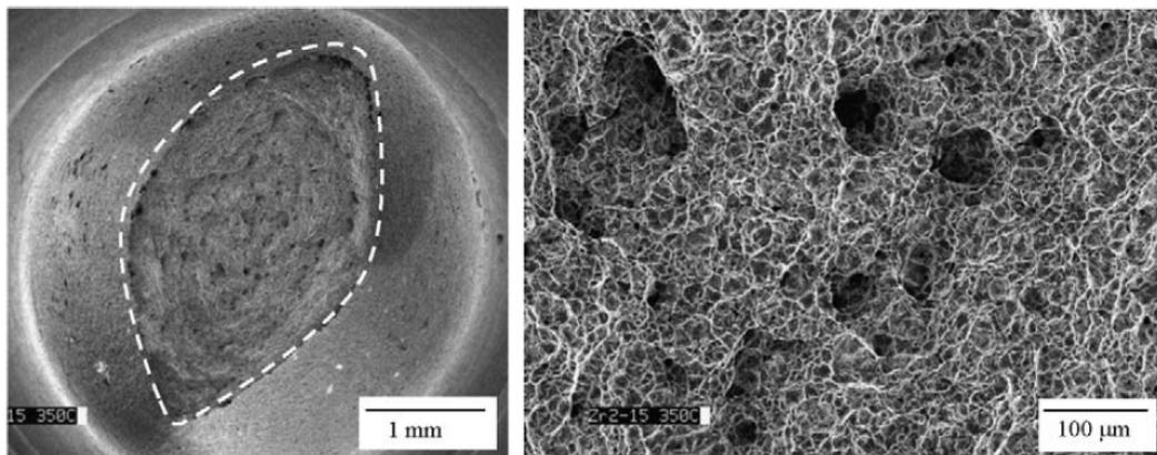
FIGURE II.18 – Faciès de rupture d'une éprouvette cylindrique en Zircaloy-2 testée en traction à  $5 \times 10^{-5} \text{ s}^{-1}$  et 350 °C — micrographies MEB [186].
