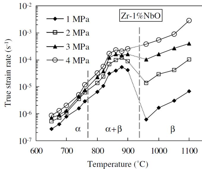
FIGURE II.8 – Évolution de la vitesse de déformation en fonction de la température, essais de fluage axial sous vide sur gaine en M5<sup>®</sup> [143].
