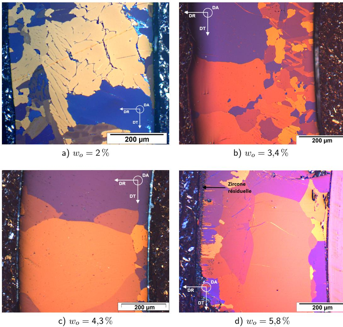
FIGURE III.31 – Micrographies optiques en lumière polarisée des gaines « modèles » base M5<sup>®</sup>, oxydées sous vapeur à 1100 °C puis traitées thermiquement sous vide 3 h à 1200 °C et testées en fluage.
