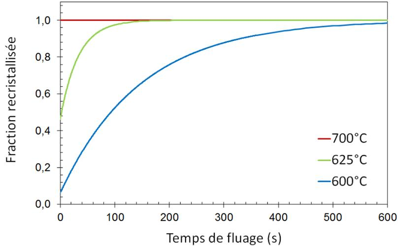
FIGURE II.26 – Évolution de la fraction de matière recristallisée dans le Zircaloy-4 pendant l’essai de fluage, après une rampe à  $25\text{ °C s}^{-1}$  et un maintien de 20 s à la température de fluage avant mise sous pression, d’après le modèle de Sills et Holt [149].
