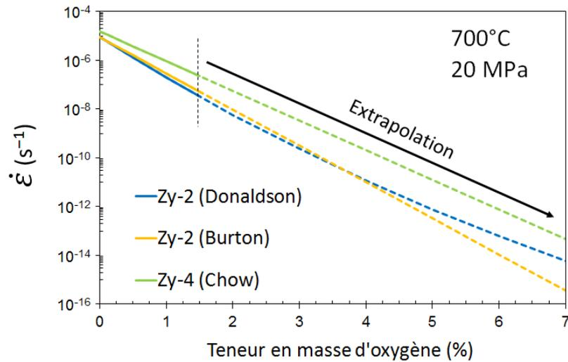
FIGURE III.18 – Extrapolation au-delà de 1,5 % en masse de l'effet durcissant de l'oxygène sur le comportement en fluage sous 20 MPa à 700 °C, d'après les lois de fluage de Burton *et al.* [209], Donaldson [224] et Chow *et al.* [211].
