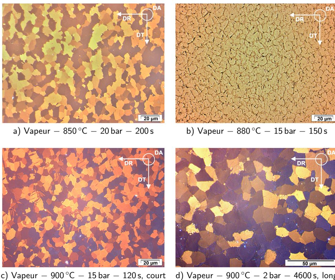
FIGURE II.44 – Microstructures après essais de fluage sous vapeur en pression interne sur Zircaloy-4 dans le domaine  $\alpha + \beta$  — micrographies optiques en lumière blanche ou polarisée.
