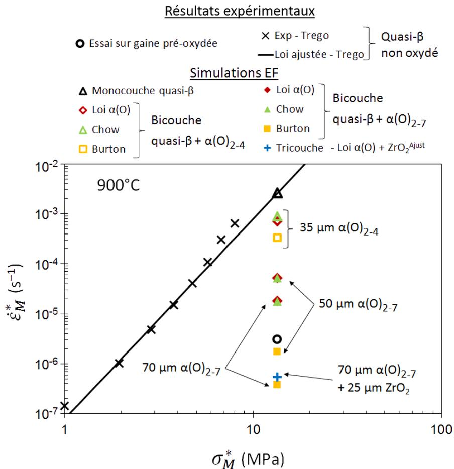
FIGURE III.68 – Vitesse de déformation équivalente en fonction de la contrainte équivalente, fluage sous vide à 900 °C — Résultats expérimentaux sur M5<sup>®</sup> après traitement thermique sous vide à 960 °C (état quasi-β) après (ou non) pré-oxydation sous vapeur à 1100 °C (voir la section II.C) — Simulations EF sur modèles bicouche et tricouche.
