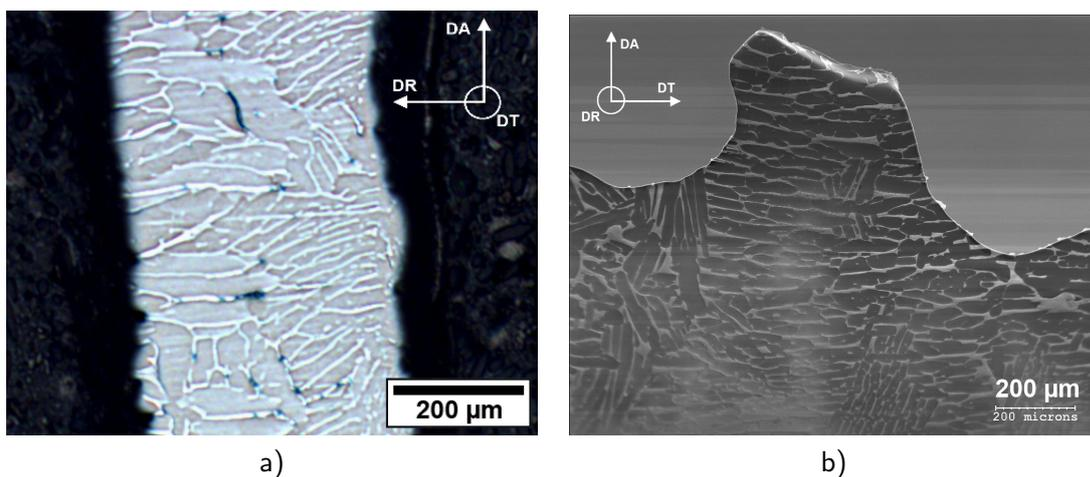
FIGURE III.38 – Micrographies a) optique dans le plan (DA, DR) et b) électronique dans le plan (DT, DA) (après une attaque chimique de dissolution sélective) — gaines « modèles » base M5® contenant 2 % en masse d'oxygène.
