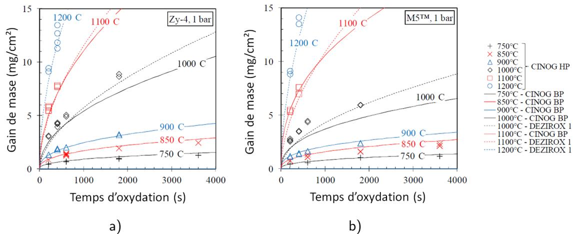
FIGURE I.22 – Cinétiques d'oxydation sous 1 bar de vapeur pour a) le Zircaloy-4 et b) le M5<sup>®</sup> — Données obtenues sur les dispositifs CINOG BP, CINOG HP et DEZIROX [42].
