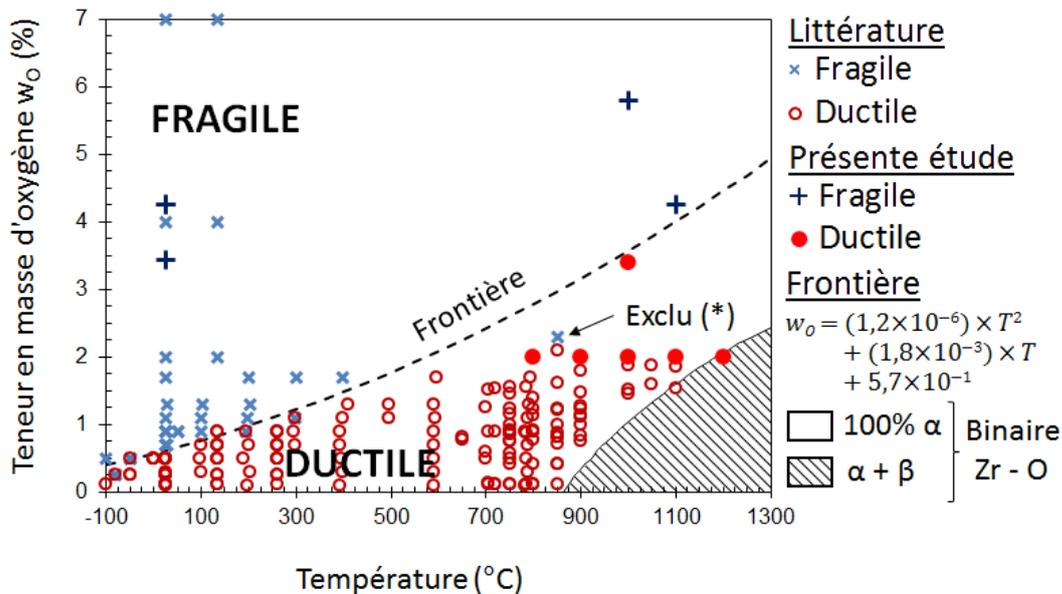
FIGURE III.48 – Transition ductile/fragile dans les alliages de zirconium en fonction de la température et de la teneur en masse d'oxygène — données expérimentales sur M5<sup>®</sup> (présente étude), Zircaloy-2 et Zircaloy-4, d'après [193] [209] [212] [221] [211] [87] et [88]. (\*) Point exclu, tiré de [193] (sollicitation indéterminée) — Transus  $\alpha/\alpha + \beta$  dans le système Zr – O d'après [58].
