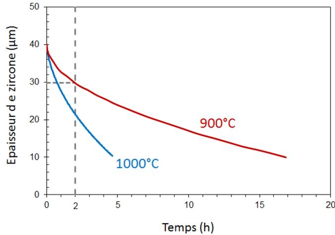
FIGURE II.57 – Évolution de l'épaisseur de zircone au cours du temps prédite à l'aide d'EKINOX + Zircobase [120] — Dissolution d'une couche initiale de 40 µm de zircone sous vide secondaire à 900 et 1000 °C.
