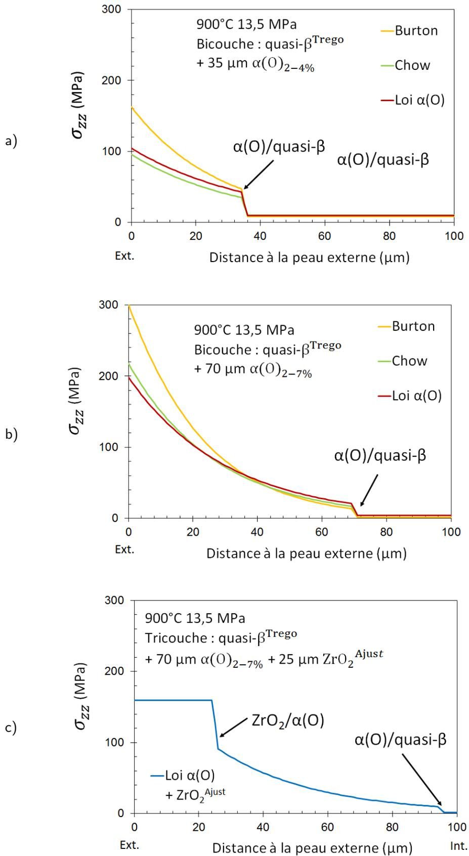
FIGURE III.69 – Profil dans l'épaisseur de la contrainte axiale  $\sigma_{zz}$  — Simulations EF d'un essai de fluage en traction axiale sous 13,5 MPa à 900 °C, a) modèle bicouche quasi- $\beta^{\text{Treg}}$  +  $\alpha(\text{O})_{2-4}$ , b) modèle bicouche quasi- $\beta^{\text{Treg}}$  +  $\alpha(\text{O})_{2-7}$  et c) modèle tricouche quasi- $\beta^{\text{Treg}}$  +  $\alpha(\text{O})_{2-7}$  +  $\text{ZrO}_2^{\text{Ajust}}$ .
