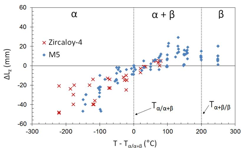
FIGURE II.28 – Variation finale de longueur des gaines après essai de fluage sous pression interne et sous vapeur pour le Zircaloy-4 et le M5<sup>®</sup>, en fonction de l'écart entre la température d'essai et leurs températures de transus respectives  $T_{\alpha/\alpha+\beta}$
