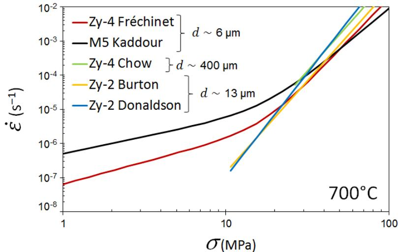
FIGURE III.19 – Comportement en fluage d'alliages de zirconium pour leurs teneurs nominales en oxygène, d'après Fréchet [1] et Chow *et al.* [211] (Zircaloy-4), Burton *et al.* [209] et Donaldson [224] (Zircaloy-2) et Kaddour [2] (M5®). Les prédictions sont réalisées sur les intervalles de validité de chaque loi de fluage et la taille de grains est indiquée dans la légende.
