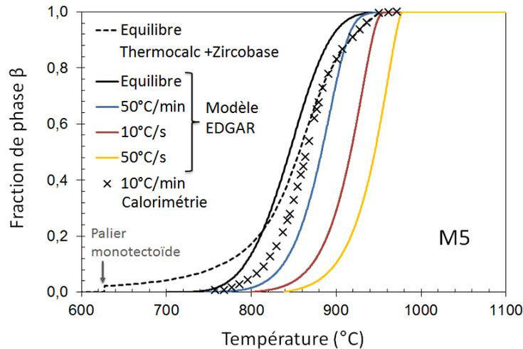
FIGURE I.18 – Évolution de la fraction de phase  $\beta$  en fonction de la température, à l'équilibre ou au chauffage — calcul Thermocalc + Zircobase, modèle phénoménologique EDGAR développés par le CEA et essais de calorimétrie [2] pour le M5<sup>®</sup>.
