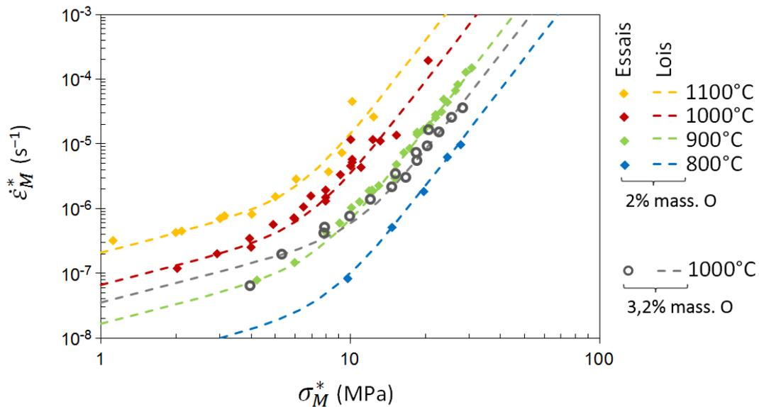
FIGURE III.42 – Vitesses de déformation en fonction de la contrainte, résultats expérimentaux de fluage axial sous vide sur matériaux « modèles » base M5<sup>®</sup> et lois de fluage identifiées.
