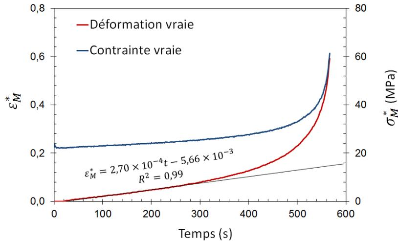
FIGURE II.30 – Déformation vraie équivalente  $\epsilon_M^*$  et contrainte vraie équivalente  $\sigma_M^*$  en fonction du temps. Essai de fluage à 800 °C, sous 33 bar de pression interne et sous vapeur sur Zircaloy-4.
