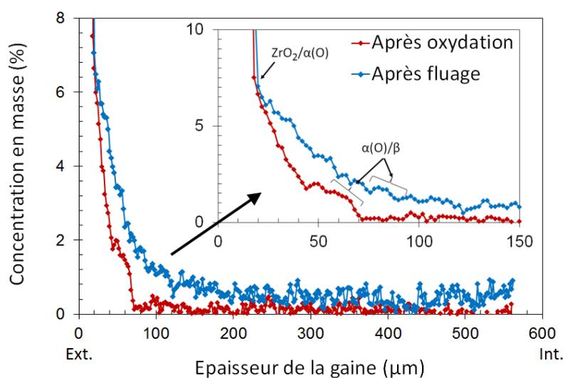
FIGURE II.59 – Profils de concentration en oxygène, mesurée par microsonde dans l'épaisseur de la gaine en base M5<sup>®</sup>, après pré-oxydation sous vapeur 467 s à 1030 °C ou après pré-oxydation et traitement thermique sous vide de 1 min à 960 °C suivi d'un essai de fluage à 900 °C.
