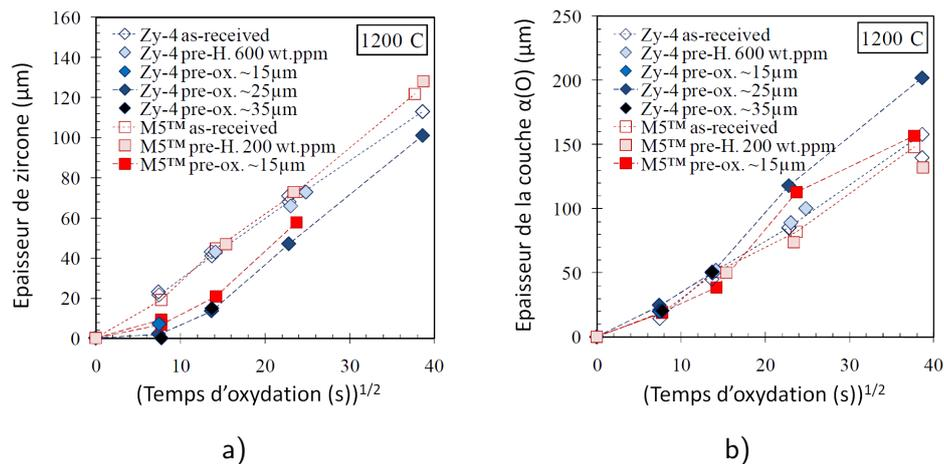
FIGURE I.23 – Croissance des couches a) de zircone et b) de phase  $\alpha(O)$  durant l'oxydation à 1200 °C sous 1 bar de vapeur pour le Zircaloy-4 et le M5<sup>®</sup>, à l'état de réception, préoxydés ou préhydrurés — Données obtenues sur le dispositif DEZIROX [117].
