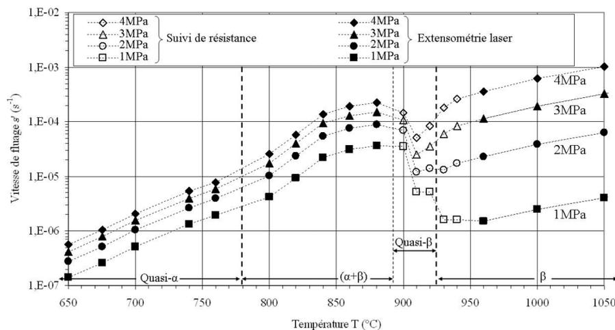
FIGURE II.9 – Évolution de la vitesse de déformation en fonction de la température, essais de fluage axial sous vide sur éprouvettes de traction uniaxiale prélevées dans une tôle en alliage M5<sup>®</sup> [3].
