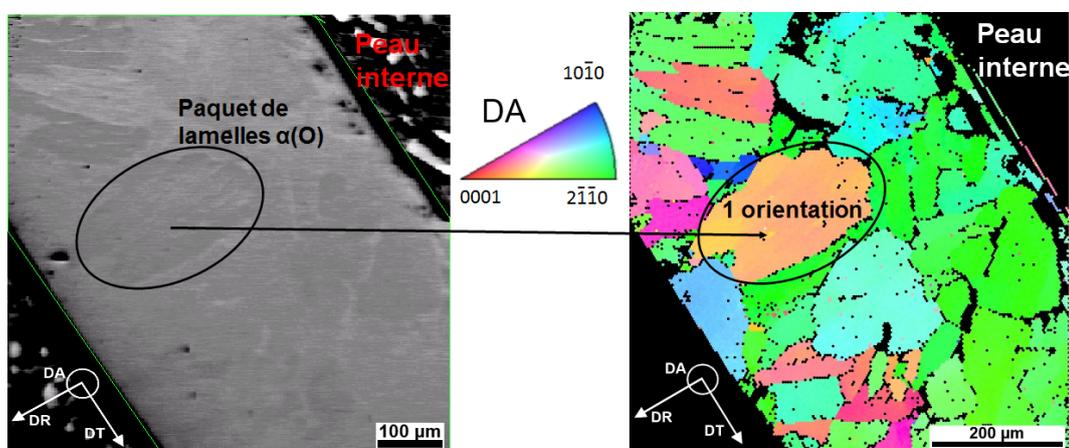
FIGURE III.37 – a) micrographie électronique et b) cartographie de la texture locale : figure de pôle inverse recalculée pour la direction axiale DA — gaine « modèle » base M5<sup>®</sup> (oxydée sous vapeur 110 s à 1100 °C puis traitée thermiquement sous vide 3 h à 1200 °C).
