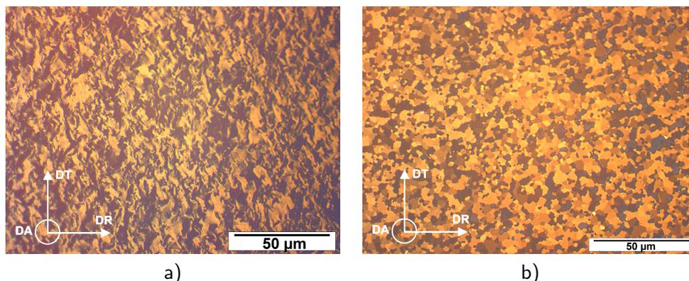
FIGURE I.9 – Microstructure à l'état de réception de gaines a) en Zircaloy-4 et b) en M5<sup>®</sup> — micrographies optiques en lumière blanche (présente étude).
