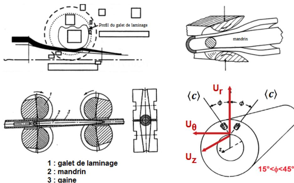
FIGURE I.8 – Schéma d'un laminoir à pas de pèlerin et orientation typique des axes  $\langle c \rangle$  d'une gaine combustible.
