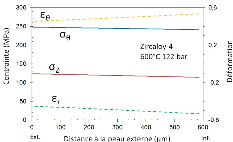
FIGURE III.67 – Profil dans l'épaisseur des contraintes et déformations ( $\epsilon_M^* = 0,41$ ) — Simulation EF de l'essai de fluage sous vapeur à 600 °C sous 122 bar de pression interne sur Zircaloy-4.
