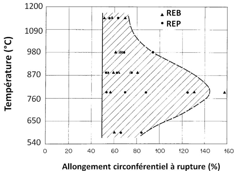
FIGURE II.16 – Allongement circonférentiel à rupture  $A_t$  en fonction de la température. Essais de fluage isothermes sous pression interne sous argon sur gaines en Zircaloy-4 pour deux dimensions typiques utilisées en REP et en réacteur à eau bouillante (REB) [184].
