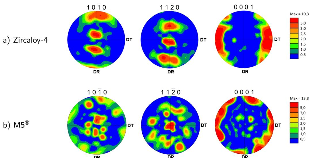
DA : direction axiale, DR : direction radiale, DT : direction tangentielle (ou circonférentielle)
