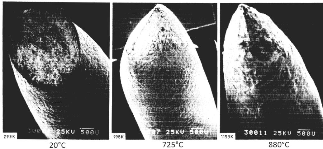
FIGURE II.17 – Faciès de rupture d'éprouvettes cylindriques en Zircaloy-2 testées en traction à 20 et 725 °C ( $2,73 \times 10^{-3} \text{ s}^{-1}$ ) et à 880 °C ( $3 \times 10^{-2} \text{ s}^{-1}$ ) — micrographies MEB [166].
