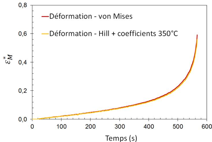
FIGURE II.29 – Déformation vraie équivalente  $\epsilon^*$  en fonction du temps selon les équivalents de von Mises ou de Hill, basé sur les coefficients d'anisotropie identifiés à 350 °C sur Zircaloy-4 recristallisé par Limon *et al.* [151]. Essai de fluage à 800 °C, sous 33 bar de pression interne (22 MPa) et sous vapeur sur Zircaloy-4.
