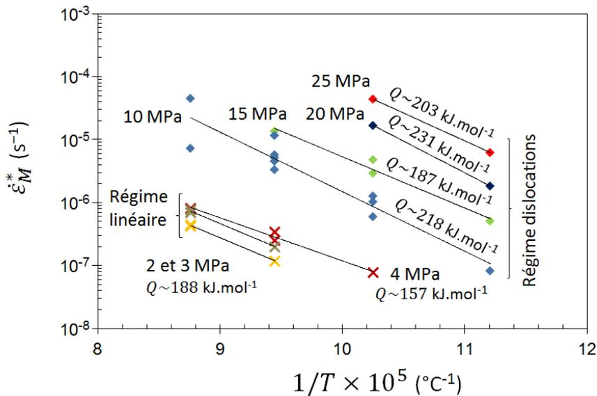
FIGURE III.41 – Vitesses de déformation en fonction de l'inverse de la température pour différents niveaux de contraintes — essais de fluage axial sous vide sur gaines « modèles » base M5<sup>®</sup> contenant  $2\%$  en masse d'oxygène.
