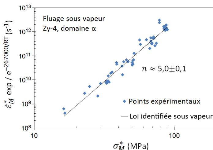
FIGURE II.39 – Vitesse de déformation normalisée par l'effet de température en fonction de la contrainte mécanique : identification de l'exposant de Norton  $n$  — Essais de fluage sous vapeur et sous pression interne, Zircaloy-4, domaine  $\alpha$ .
