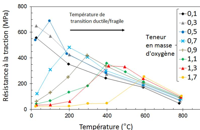
FIGURE III.12 – Évolution de la résistance à la traction en fonction de la température et de la teneur en masse d'oxygène — essais de traction sur Zircaloy-4 enrichi en oxygène, d'après [221].
