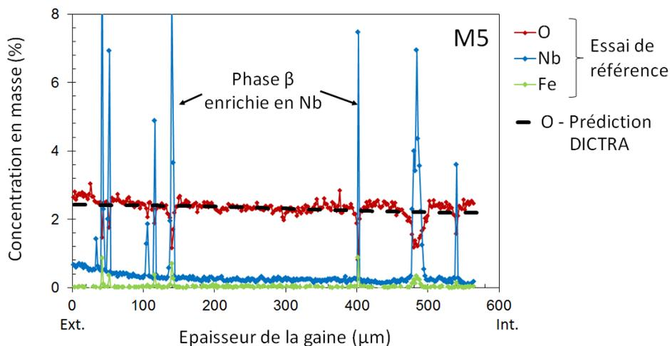
FIGURE III.30 – Profils des concentrations en masse d'oxygène, de niobium et de fer, mesurées par microsonde, dans l'épaisseur d'une gaine « modèle » base M5<sup>®</sup>, oxydée sous vapeur 467 s à 1100 °C puis traitée thermiquement sous vide 3 h à 1200 °C — Profil de la concentration en oxygène calculé pour un même traitement thermique, à l'aide du code DICTRA pour du zirconium pur avec une épaisseur initiale de zircone de 40  $\mu\text{m}$ .
