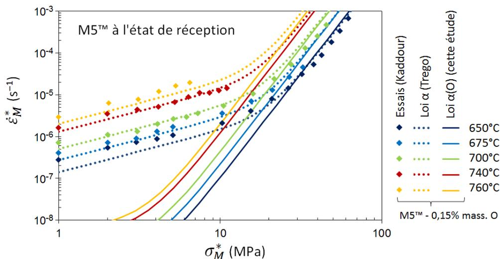
FIGURE III.54 – Vitesses de fluage en fonction de la contrainte — Essais de fluage axial sous vide dans le domaine  $\alpha$  du M5<sup>®</sup> réalisés par Kaddour [2] et prédictions à l'aide de la loi de fluage identifié par Trego [3] et de la loi de fluage  $\alpha(O)$  identifiée dans la présente étude.
