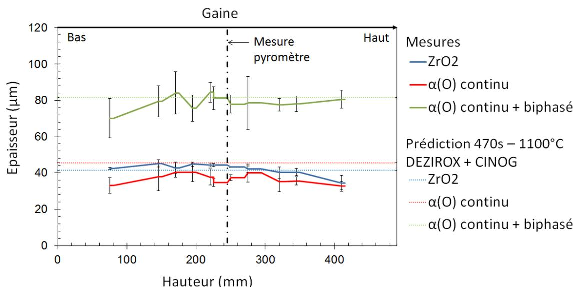
FIGURE III.25 – Épaisseurs moyennes de zircone et de phase  $\alpha(O)$  à différentes hauteurs d'une gaine en M5<sup>®</sup> oxydée sous vapeur dans EDGAR 470 s à 1100 °C et comparaison avec les prédictions faites à l'aide des données DEZIROX + CINOG BP [42].
