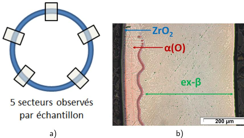
FIGURE F.1 – a) Schéma des cinq secteurs observés par échantillon et b) exemple de mesure de l'épaisseur de la couche  $\alpha(O)$  à l'aide du logiciel ImageAnalysis — Gaine en M5<sup>®</sup> pré-oxydée sous vapeur 467 s à 1100 °C (échantillon prélevé avant fluage).
