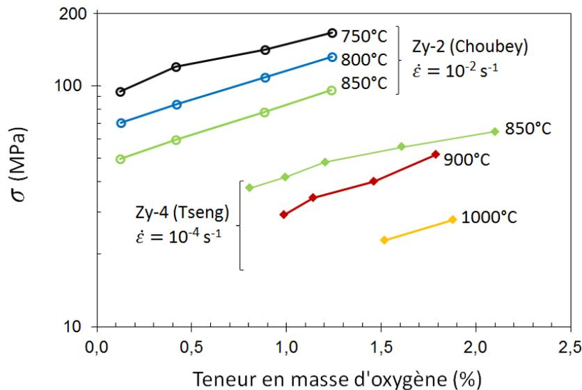
FIGURE III.16 – Évolution de la contrainte à l'état de quasi-équilibre en fonction de la température et de la teneur en masse d'oxygène — essais de compression dans le domaine  $\alpha$  sur Zircaloy-2 à  $\dot{\epsilon} = 10^{-2} \text{ s}^{-1}$  [212] [213] et sur Zircaloy-4 à  $\dot{\epsilon} = 10^{-4} \text{ s}^{-1}$  [87].
