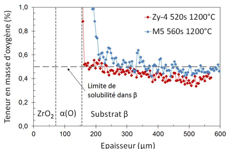
FIGURE III.3 – Profils de diffusion de l'oxygène, mesurés par microsonde, dans les épaisseurs de gaines en Zircaloy-4 et en M5<sup>®</sup> oxydées à 1200 °C sous vapeur [120]. Les interfaces pour le Zircaloy-4 sont repérées en pointillés.
