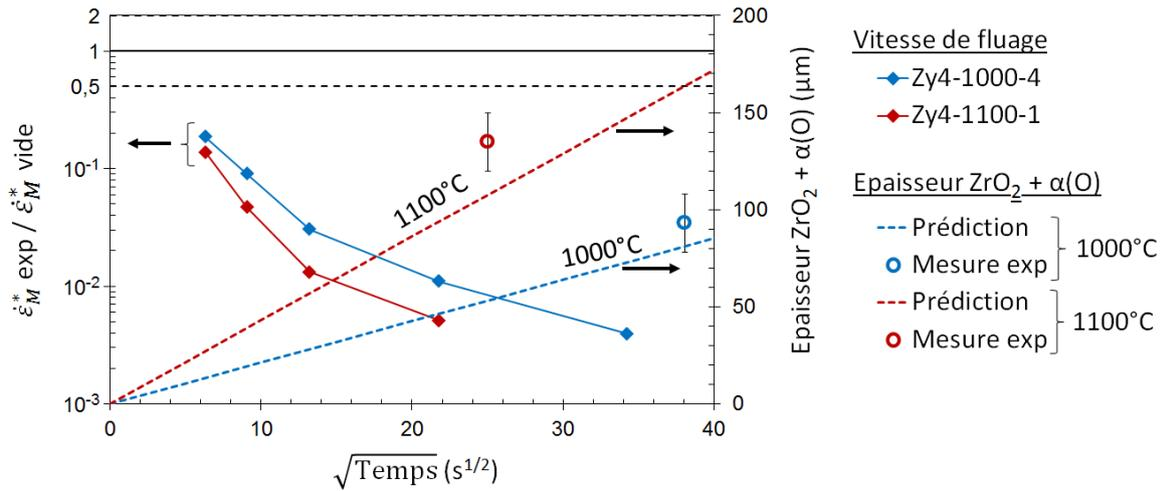
FIGURE II.54 – Évolution en fonction de la racine carrée du temps de l'accord vide/vapeur (à gauche, à partir de la loi de fluage sous vide identifiée par Fréchet [1]) et de l'épaisseur cumulée de zircon et de phase  $\alpha(O)$  (à droite, d'après les données DEZIROX + CINOG BP [117]) — Zircaloy-4, domaine  $\beta$ .
