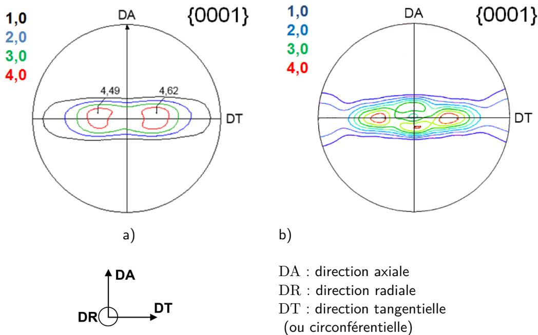
FIGURE I.10 – Figures de pôles {0001} obtenues par diffraction des rayons X pour des gaines a) en Zircaloy-4 [1] et b) en M5<sup>®</sup> [2].
