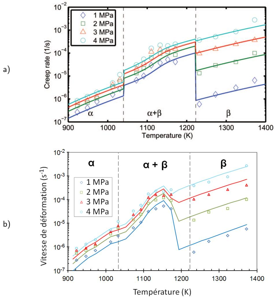
FIGURE II.12 – Évolution de la vitesse de déformation en fonction de la température, essais de fluage axial sous vide sur gaine en M5<sup>®</sup> [143] et simulation à l'aide a) d'un modèle de Ashby-Verrall [173] [172] basé sur les lois de fluage de Kaddour [143] et b) d'une loi de mélange basée sur les lois de fluage de Trego [3].
