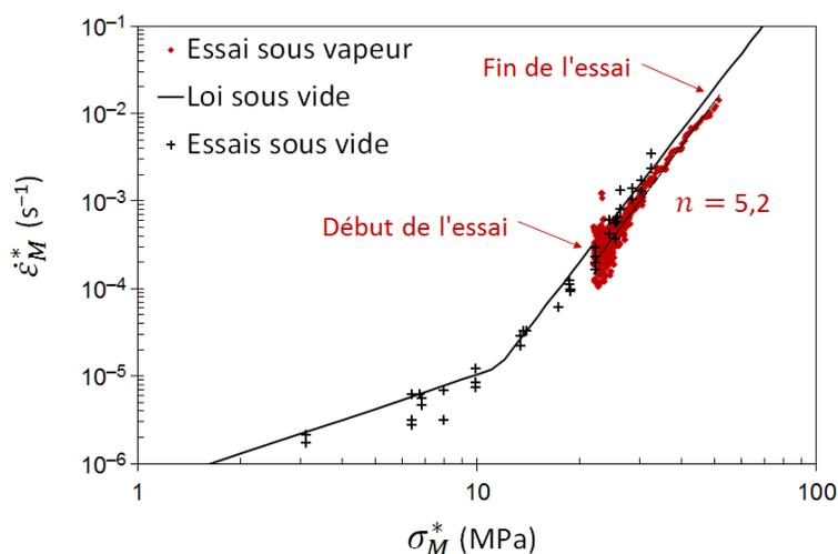
FIGURE II.32 – Évolution de la vitesse de déformation équivalente  $\dot{\epsilon}_M^*$  en fonction de la contrainte équivalente  $\sigma_M^*$ . Loi et essais de fluage sous vide à 800 °C [1], essai de fluage à 800 °C, sous 33 bar de pression interne et sous vapeur, sur Zircaloy-4.
