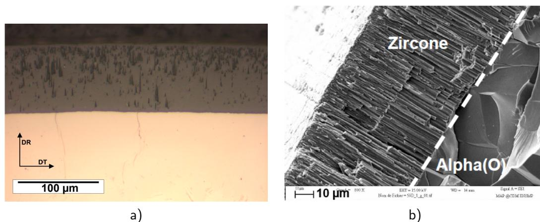
FIGURE III.21 – a) micrographie optique de la couche de zirconite de la gaine en M5<sup>®</sup> testée en fluage sous 5 bar à 1100 °C sous vapeur pendant 1000 s et b) fractographie en microscopie électronique de la couche de zirconite d'un anneau en Zircaloy-4 oxydé 520 s à 1200 °C puis testé en compression à 20 °C [22].
