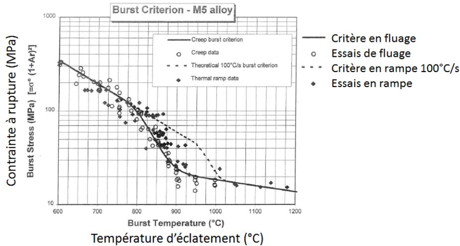
FIGURE I.6 – Critère de rupture par éclatement pour l’alliage M5<sup>®</sup> et données d’essai EDGAR pour l’alliage M5<sup>®</sup> [40].
