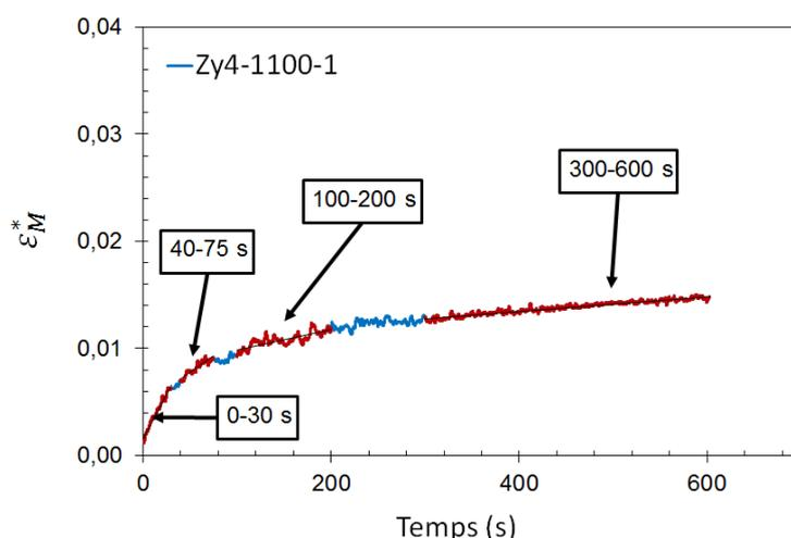
FIGURE II.50 – Déformation vraie équivalente  $\epsilon_M^*$  en fonction du temps. Essai de fluage Zy4-1100-1 à 1100 °C, sous 5 bar ( $\sigma_M^* = 2,8$  MPa) de pression interne et sous vapeur sur Zircaloy-4. Les intervalles de temps sur lesquels la vitesse de fluage a été estimée sont en rouge.
