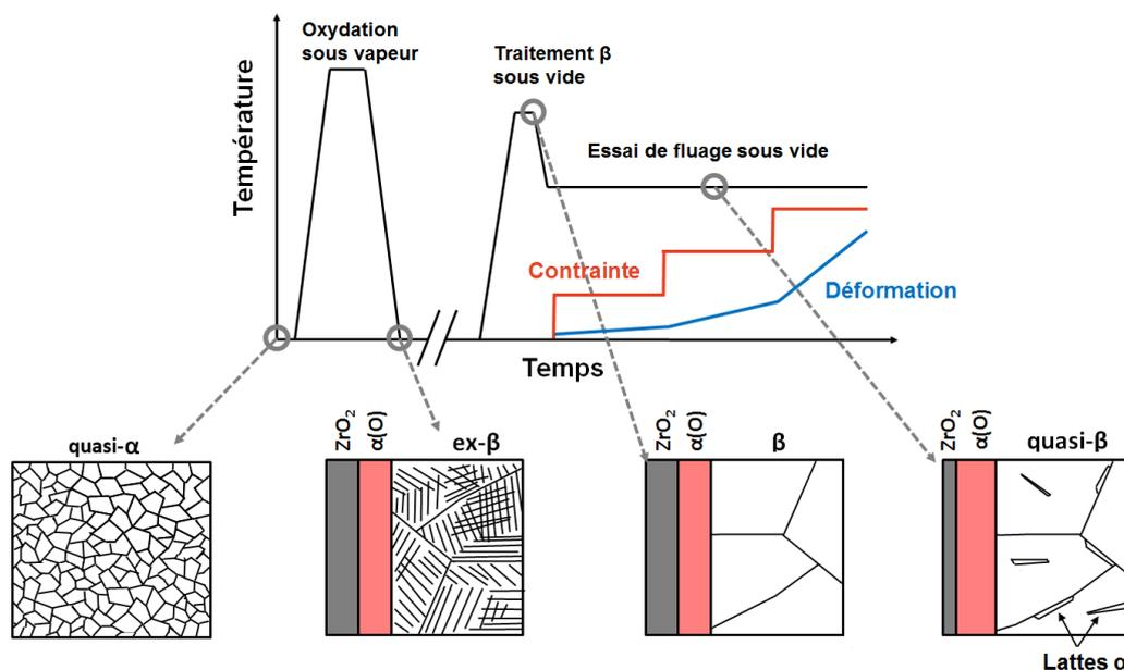
FIGURE II.56 – Schéma du cycle thermo-mécanique de l'essai de fluage axial sous vide sur gaine en M5<sup>®</sup> pré-oxydée sous vapeur à haute température ; microstructures schématisées de la gaine aux différentes étapes de l'essai (peau externe à gauche).
