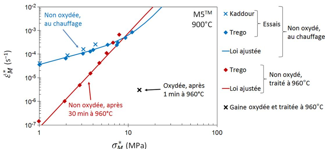
FIGURE II.61 – Vitesses de déformation équivalente  $\dot{\epsilon}_M^*$  en fonction de la contrainte équivalente  $\sigma_M^*$  — Essais de fluage axial sous vide sur M5<sup>®</sup>, non oxydé au chauffage [2] [3], non oxydé et traité 30 min à 960 °C [3] ou pré-oxydé sous vapeur 467 s à 1030 °C puis traité 1 min à 960 °C.
