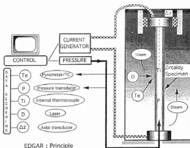
FIGURE II.23 – Schéma de principe du dispositif expérimental EDGAR [40].
