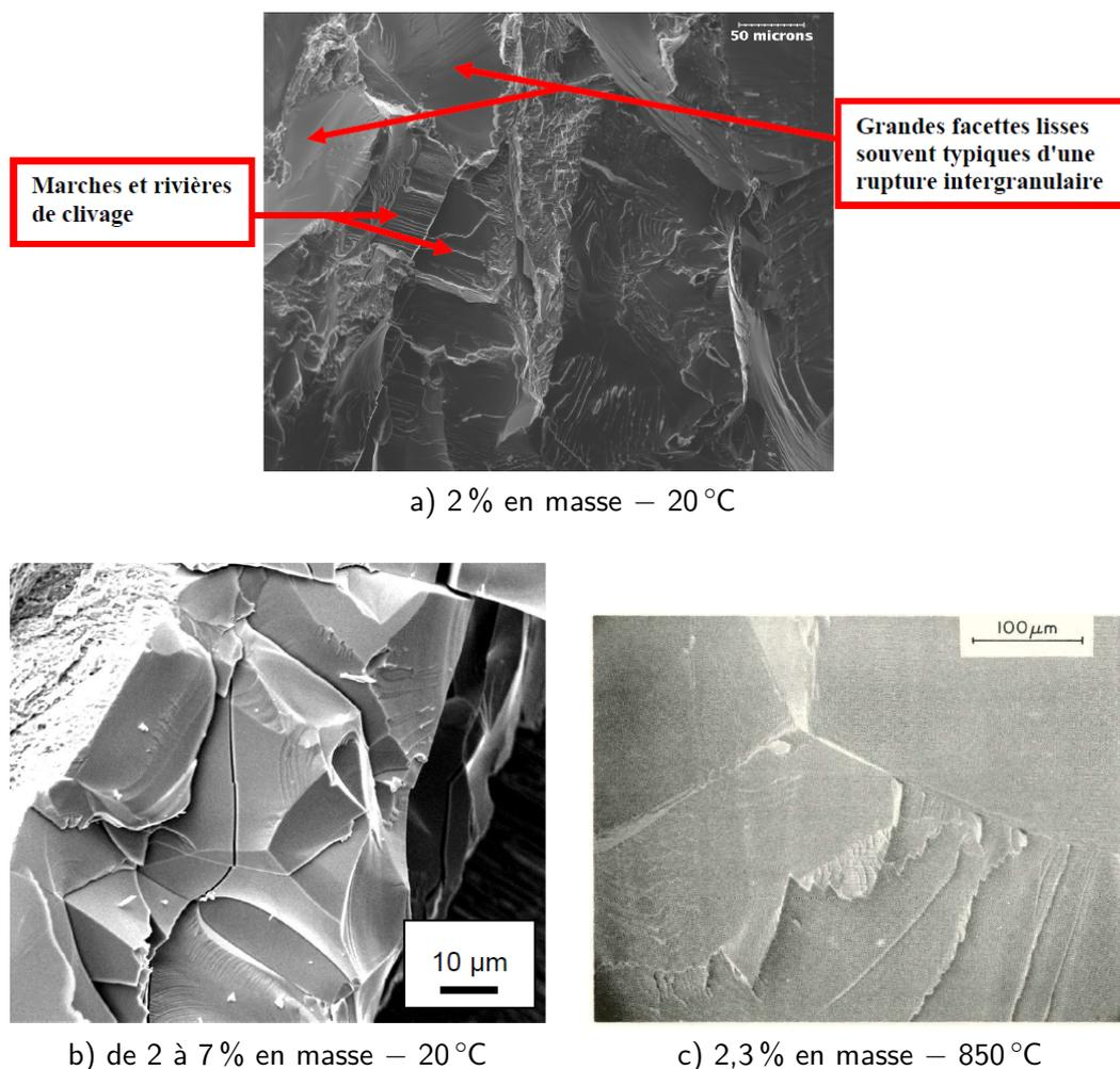
FIGURE III.13 – Fractographies en microscopie électronique a) plaque en Zircaloy-4 contenant 2 % en masse d'oxygène rompue par flexion à 20 °C [88] [222], b) de la couche  $\alpha(O)$  d'un anneau en Zircaloy-4 oxydé 520 s à 1200 °C puis testé en compression à 20 °C [22] et c) d'une éprouvette de traction en Zircaloy-4 contenant 2,3 % en masse d'oxygène rompue à 850 °C [193].
