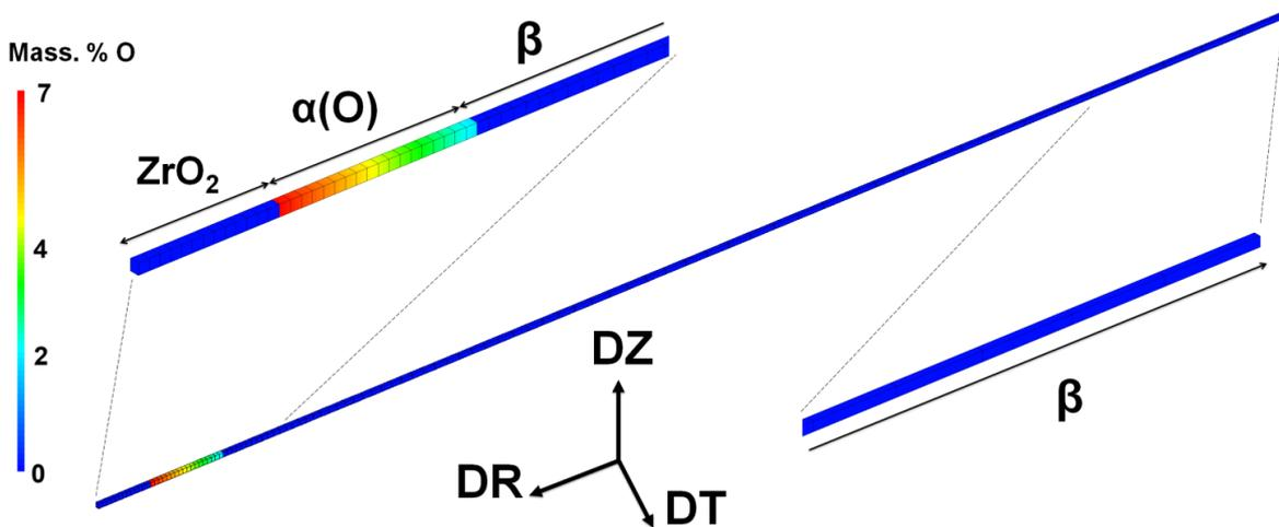
FIGURE III.62 – Schéma du maillage d'un secteur de gaine pour le modèle tricouche  $\beta + \alpha(O)_{2-7} + ZrO_2$ , avec dans la couche  $\alpha(O)$  un gradient linéaire de la concentration en oxygène.
