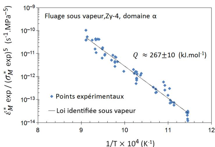
FIGURE II.38 – Vitesse de déformation normalisée par la contrainte mécanique en fonction de l'inverse de la température : identification de l'énergie d'activation  $Q$  du régime de fluage — Essais de fluage sous vapeur et sous pression interne, Zircaloy-4, domaine  $\alpha$ .
