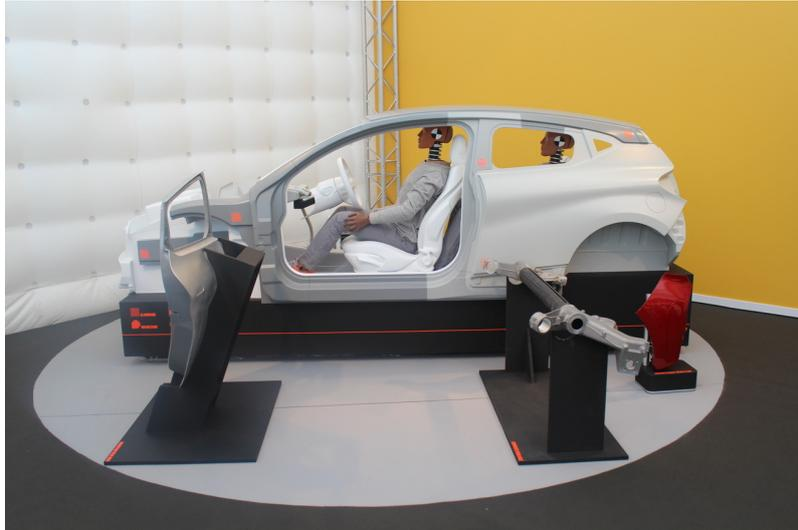
FIGURE 2.7 – Le projet *Eolab*, lancé en avril 2012 et baptisé Super ALMA en interne de l'ex-Régie (Architecture for Low Mass and Aerodynamics) ne s'arrête pas à un *concept car* et vise l'industrialisation des technologies testées et brevetées par le constructeur français. La traverse d'essieu composite reliant des bras en alliage d'aluminium est visible sur le présentoir de droite.
